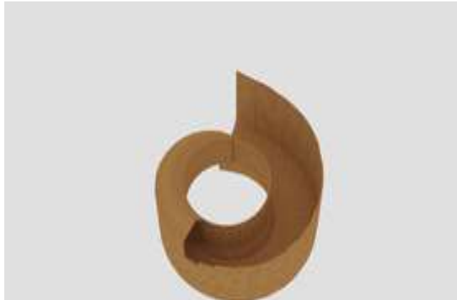
PX泵房蜗壳模板拼接动画模拟
