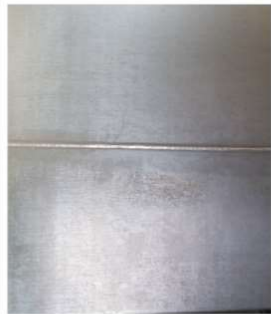
风管自动焊成型效果
