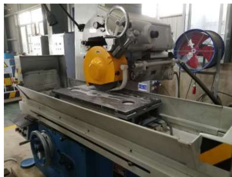
压力容器垫板加工
