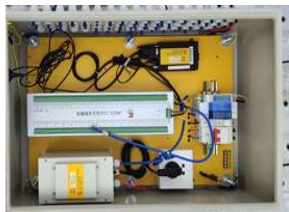
大体积砼测温自动监测预埋元件
