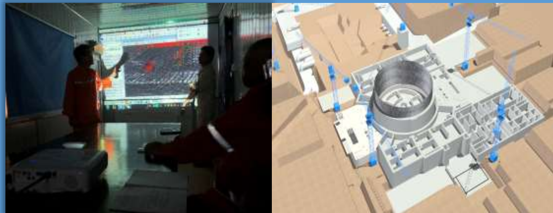
利用BIM可视化技术模拟施工过程动画，清晰地展示了各施工逻辑顺序，对专项方案的合理编制提供了直观的参考
