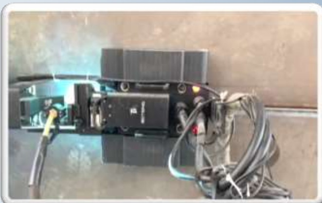
磁吸无轨MAG自动焊
