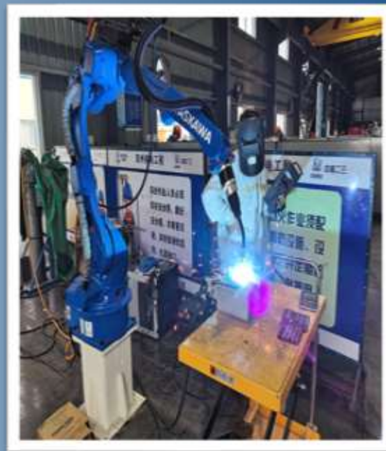
电气盖板自动焊
