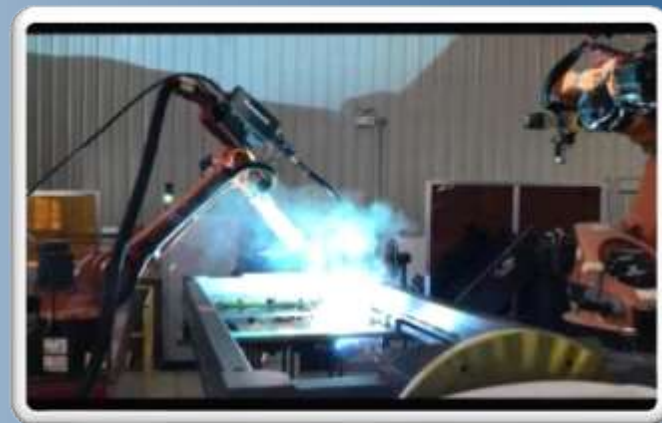
穿孔机器人塞焊
