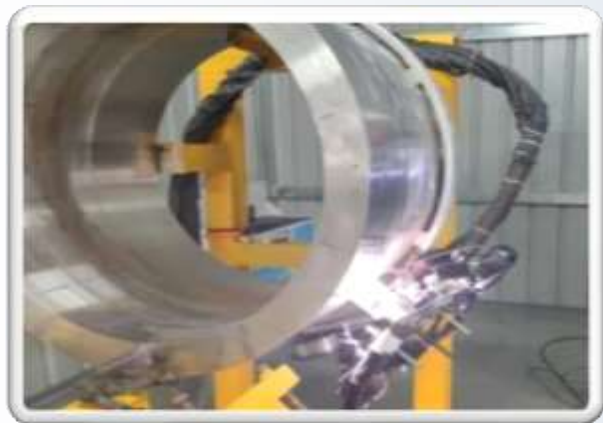
厚壁管道自动焊
