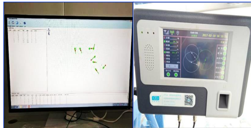
塔吊防碰撞系统
