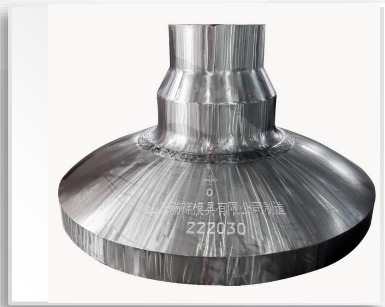
稳压器波动管筒体与接管焊接缺陷试块
