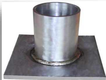
管板对接焊接试块
