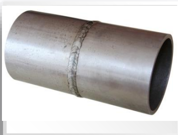
管管对接焊接试块
