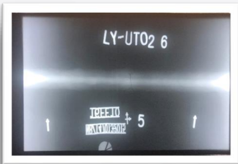
横向裂纹X光片
