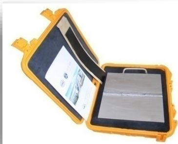
板板对接焊接试块
