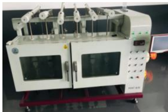
耐慢速裂纹增长试验机
