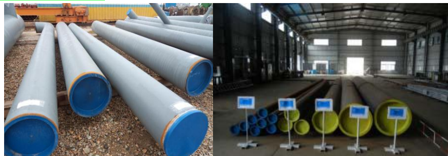
4.2 管道封口效果照片
