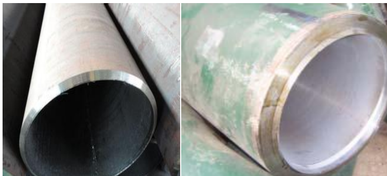
4.1 管道坡口效果照片
