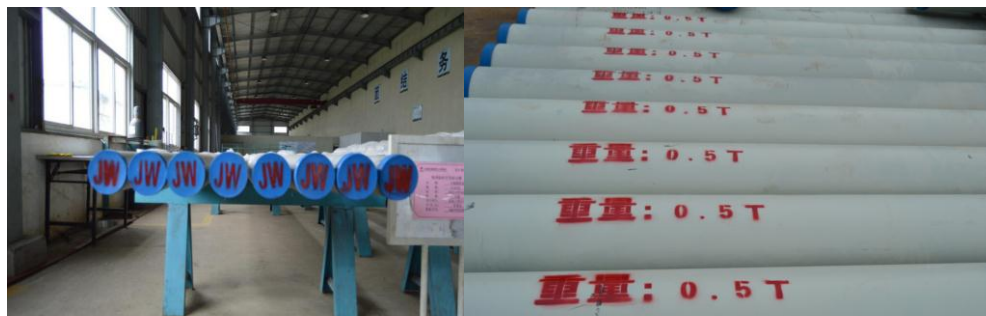
4.3 管道标识效果照片
