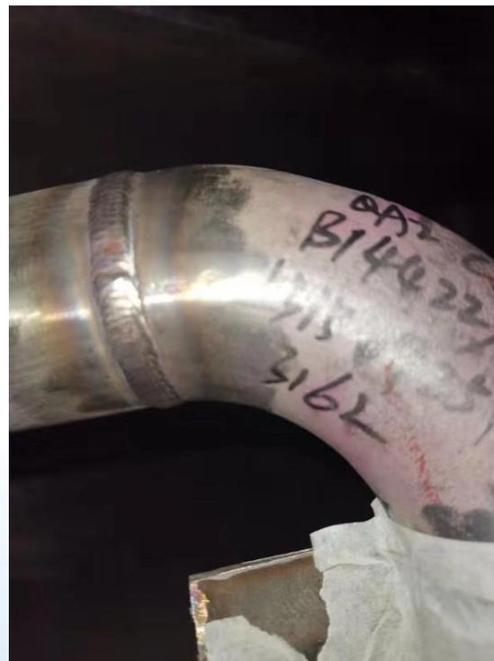
核燃料装卸系统管道焊缝表面无咬边、裂纹、焊瘤、气孔、弧坑等缺陷，焊肉饱满、过渡平滑、外形美观。
